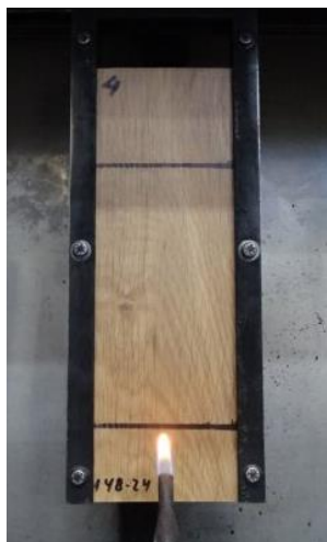
Fotografia 5 – Ensaio com o queimador aplicado na superfície do corpo de prova.
